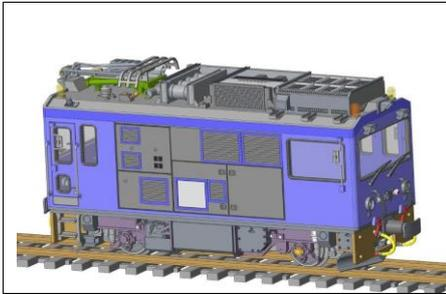
**Kleinserie mit 2 Achsantrieb ohne Zahnrad, Mischbauweise, Resin- und Neusilber sowie Messing Feinguss Teile.**
